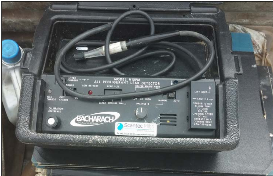
Figur 8. HDI-mätare för registrering av halogenerade kolväten.
